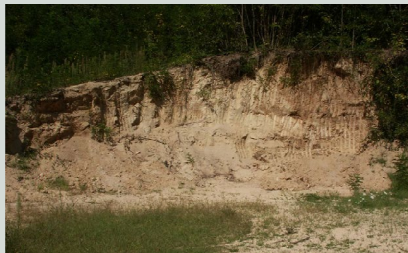
Extraction de sable issu de la désagrégation du granite (arène)
