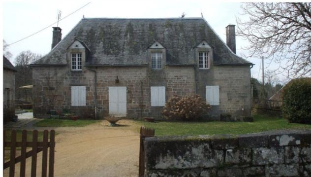
Corps de ferme avec maisons de maître à *la Jugie* : toitures couvertes d'ardoises en quatre eaux, avec lucarnes engagées dissymétriques (à gauche) ou châssis de toit (à droite).
