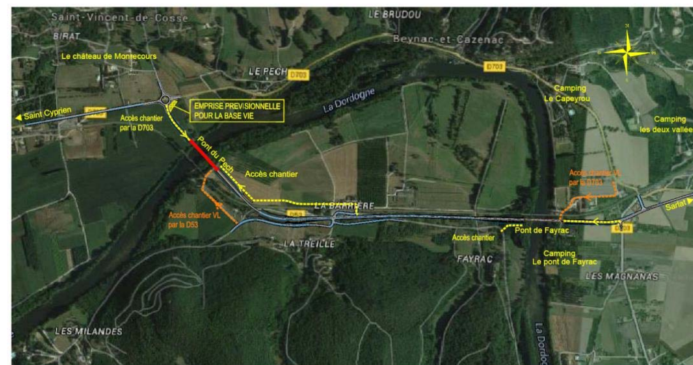
Figure 9 : Plan d'implantation de la base vie et des accès chantier (Source : setec tpi, juillet 2016)
