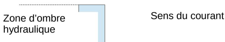
Zone située à l'arrière d'un bâtiment ou ouvrage existant par rapport au sens du courant. Le fait d'implanter un bâtiment dans l'ombre hydraulique d'un autre bâtiment limite son effet d'obstacle à l'écoulement.
