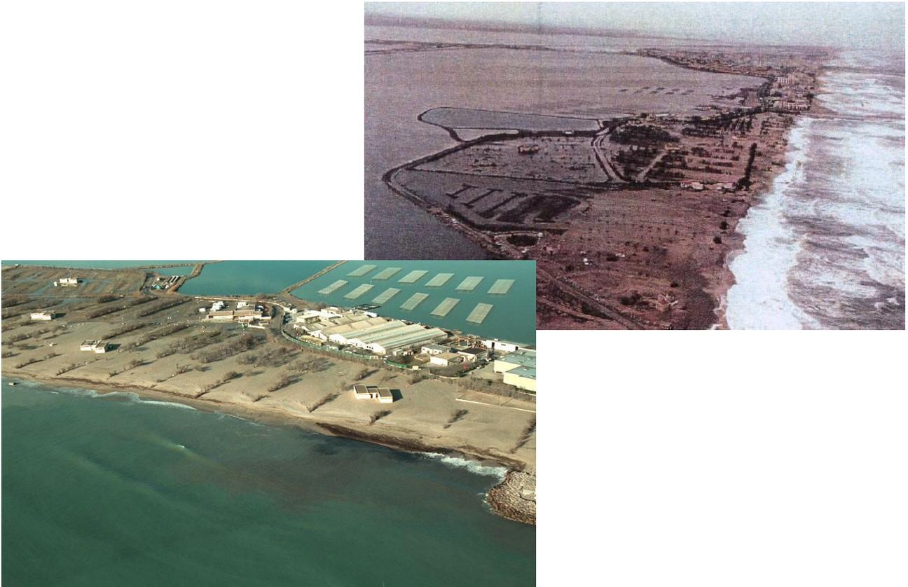
Sur ces vues post-tempête, on constate la disparition complète de plus de 50 m de plage. On remarque la « falaise d'érosion » causée par les vagues et les probables intrusions marines.
