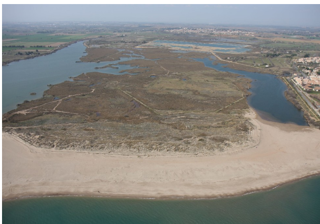
Le grau est fermé par une accumulation des sables marins transportés par les courants littoraux. Sa réouverture pour l'évacuation des eaux nécessite une forte crue
