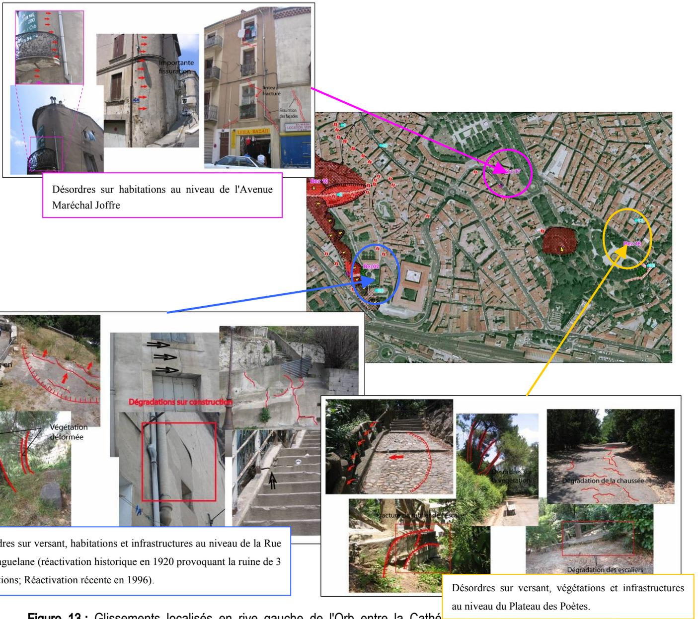
**Figure 13 :** Glissements localisés en rive gauche de l'Orb entre la Cathédrale et le Plateau des Poètes ., Désordres au niveau de la rue Longuelane (réactivation en 1920, provoquant la ruine de 3 habitations., réactivation récente en 1996 sans dégâts notables), de l'avenue Maréchal Joffre et du Plateau des Poètes.
