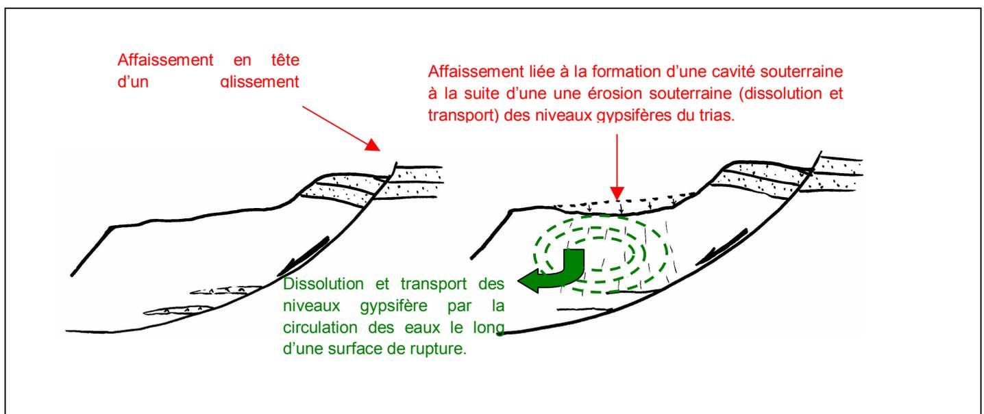
**Figure 35 :** Exemple d'une zone d'affaissement naturelle sur les commune de Pégairolles de l'Escalette et de Lauroux et mécanisme possible de leur mise en place
