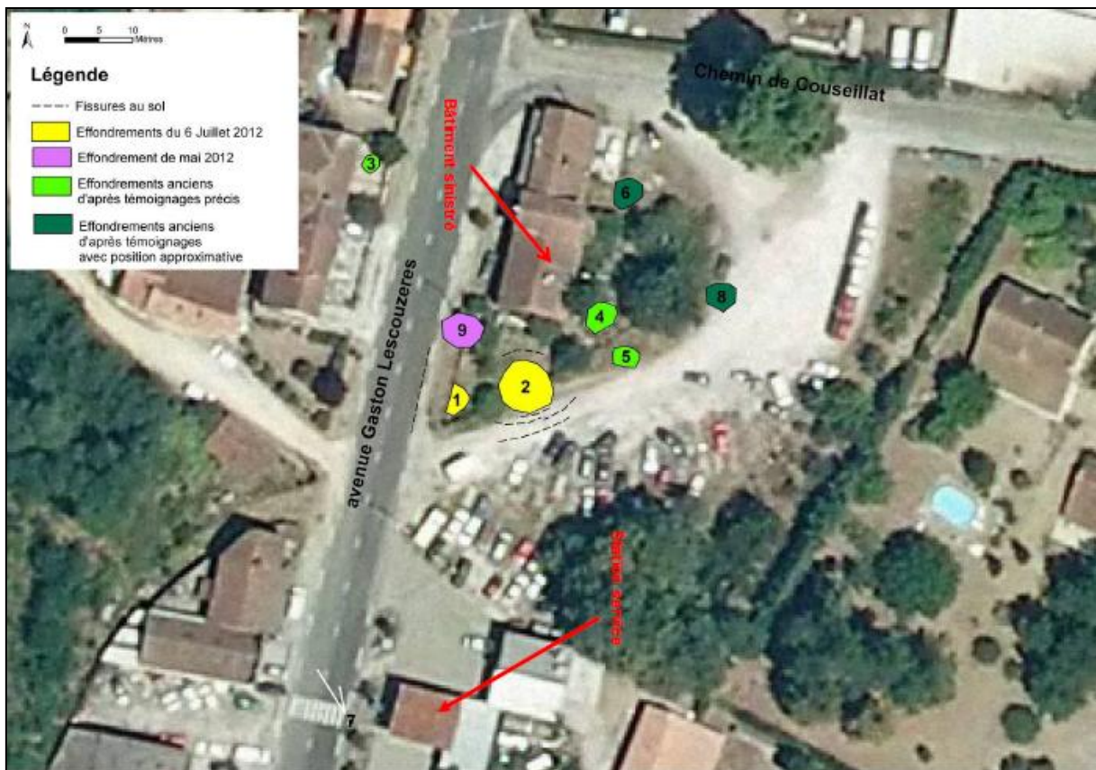
Figure 42 : Carte des désordres relevés dans le cadre de l'expertise [Source : BRGM]
