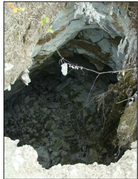
Figure 62 : Dépression présentant un effondrement d'environ 1 m de diamètre au centre, les parois présentent un dévers marqué s'étendant à plusieurs mètres autour du fontis (désordre n° 3 dans l'étude BRGM) [Source : IMS RN ]
