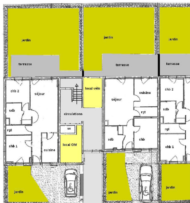
Logements adaptés du rez-de-chaussée
