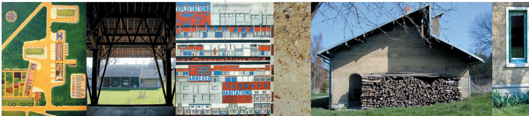
La rationalisation de la construction apparaît sur les panneaux de présentation du projet, publiés en mars 1949 dans le n°22 de la revue *Architecture d'aujourd'hui*. En blanc, figure les remplissages parpaing et chaux ou béton armé ; en gris, le béton de cailloux ou béton de terre ; en rose, le remplissage brique apparenté au parpaing ; en rouge, les éléments de bardage et en bleu les menuiseries.
