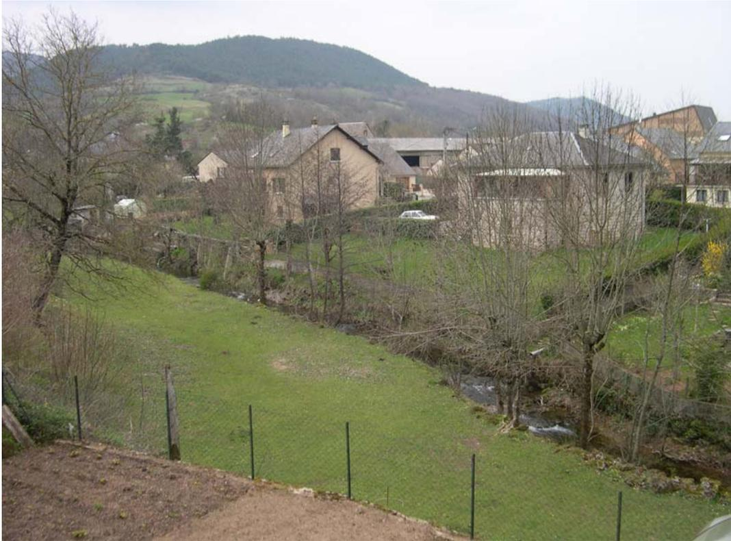
photo 11 : au premier plan au grillage, un talus de plusieurs mètres marque la limite du lit majeur du Saint Saturnin. Dans le lotissement en rive droite, la berge est en pente douce et la limite de la zone inondable n'est pas nette. Le chenal du lit mineur est bien encaissé et des murets servant de digue ont été mis en place pour parer les inondations.
